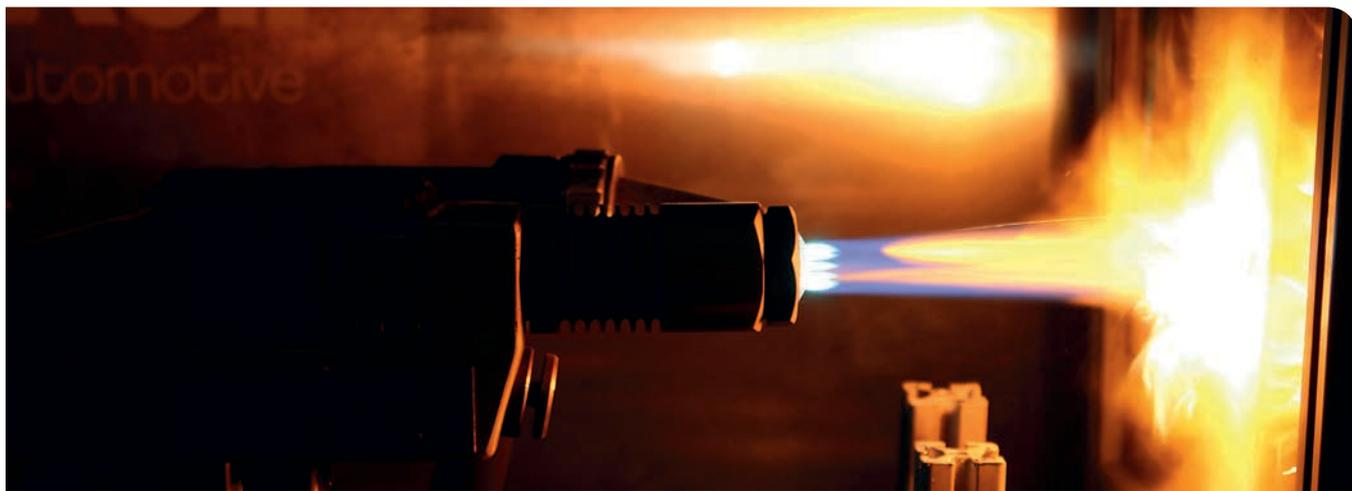
Testaufbau des weiterentwickelten Abuse-Tests mit Acetylen-Sauerstoff-Brenner und Druckregler, Strahlmittel und Sandstrahlvorrichtung.
